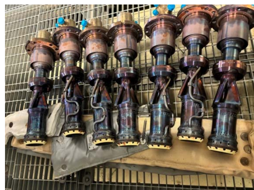
รูปที่ 3-3 หัวฉีดเผาไหม้แบบ Dry Low \text{NO}_x
